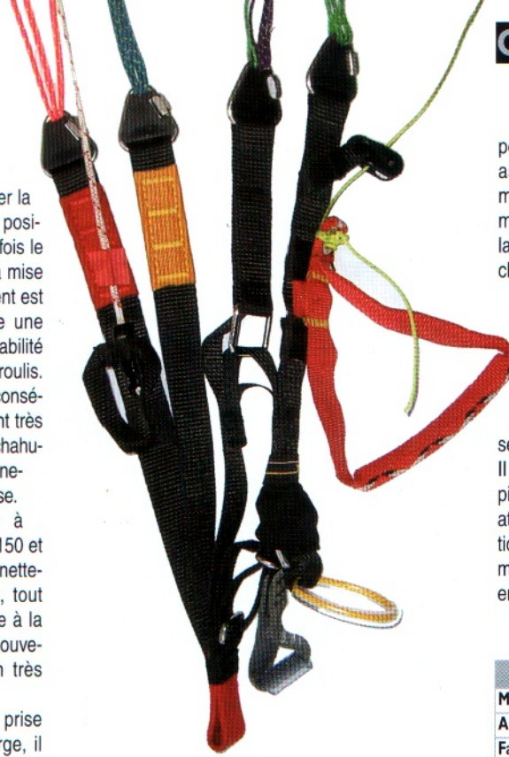
Une poignée de trims rigidifiée par un tube, donc facile à saisir. Le taquet coinçant sur le A rouge, légèrement dissimulé par la sangle, sert à bloquer le réglage d'oreilles choisi par le pilote. Efficace et reposant !
